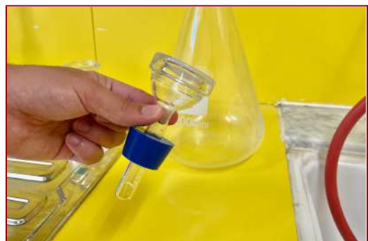
Fig. 15. Unió de la base de vidre amb la goma de silicona.
