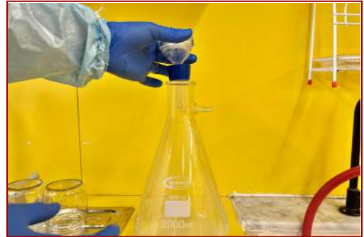
Fig. 16. Introducció de la base de vidre amb placa porosa al Kitasato.
