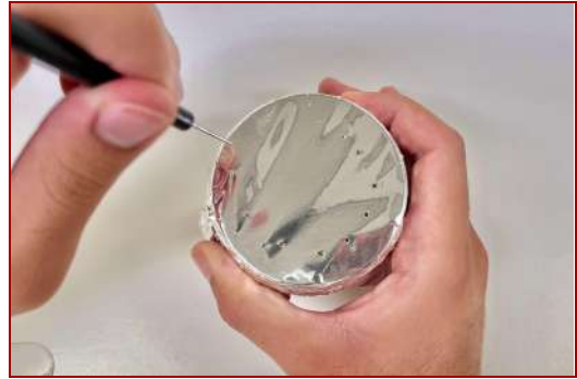
Fig. 12. Perforació de la làmina amb el punxó.
