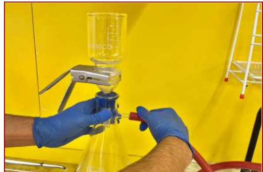
Fig. 21. Introducció de la tubuladura lateral dins del tub de goma.
