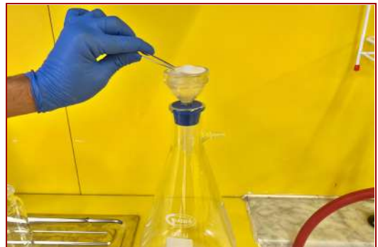
Fig. 18. Instal·lació del filtre d'1,2 \mu\text{m} a la superfície porosa.
