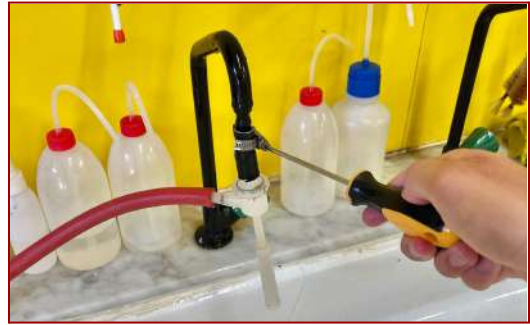
Fig. 20. Cargolar l'abraçadera a l'aixeta.
