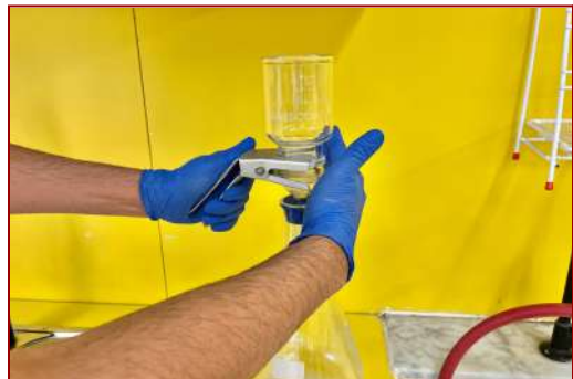
Fig. 18. Instal·lació del filtre d'1,2 \mu\text{m} a la superfície porosa.
